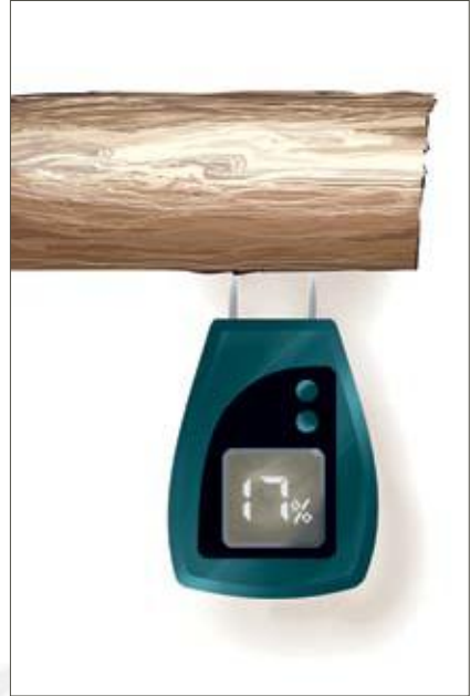
Zwei Elektroden werden in das Holz eingeschlagen. Der Widerstand beim Stromfluss ist für den Restwassergehalt bezeichnend.
